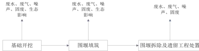
围堰施工工艺流程及产污节点图
