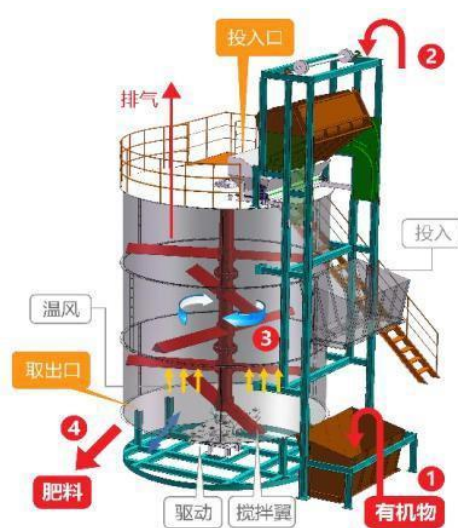
图 3.2-5 项目好氧发酵罐运行原理
