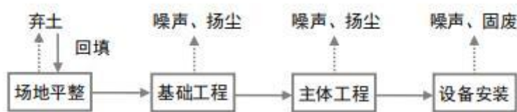
图 3.2-1 施工期工艺流程及产污环节图
