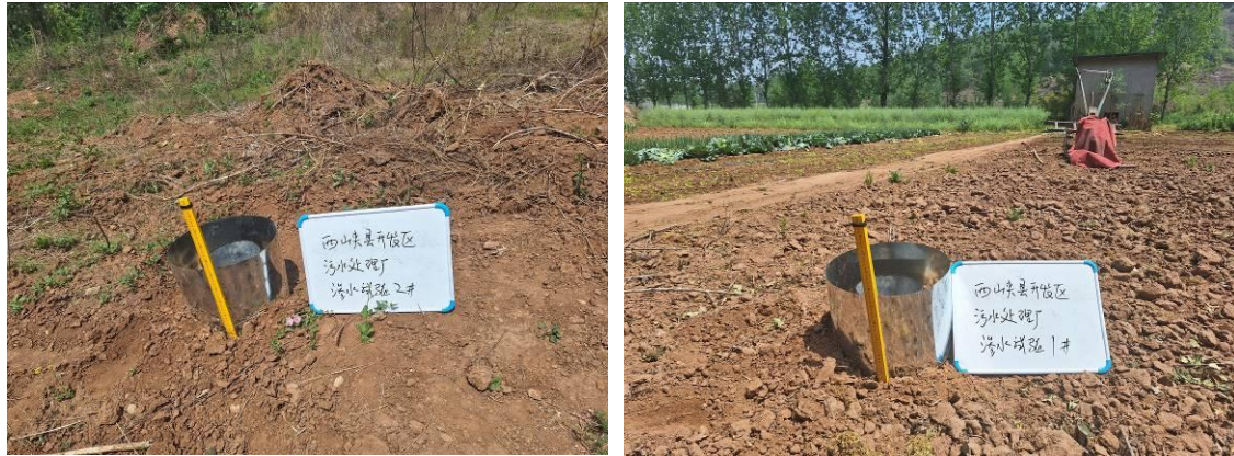
图 4.2-16 渗水试验照片
