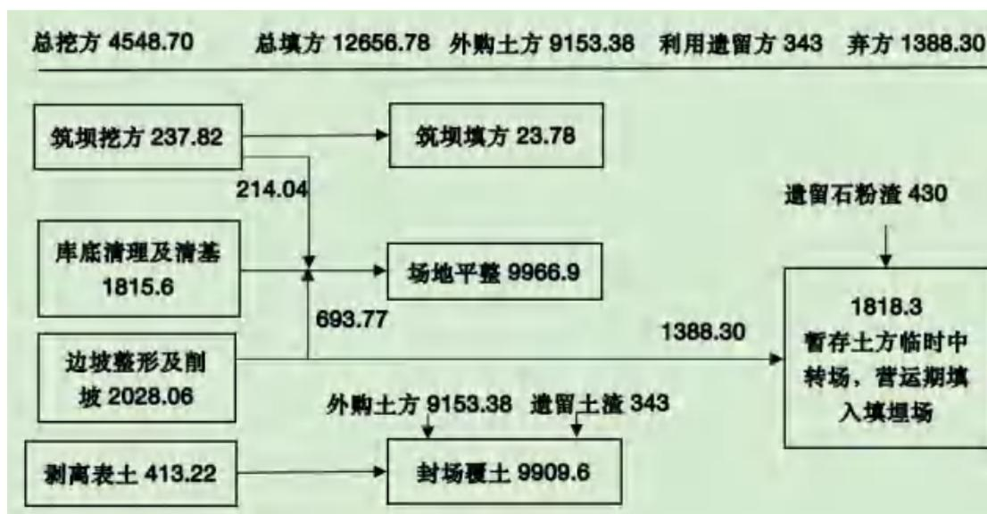
图 3-5 本项目土石方平衡图
